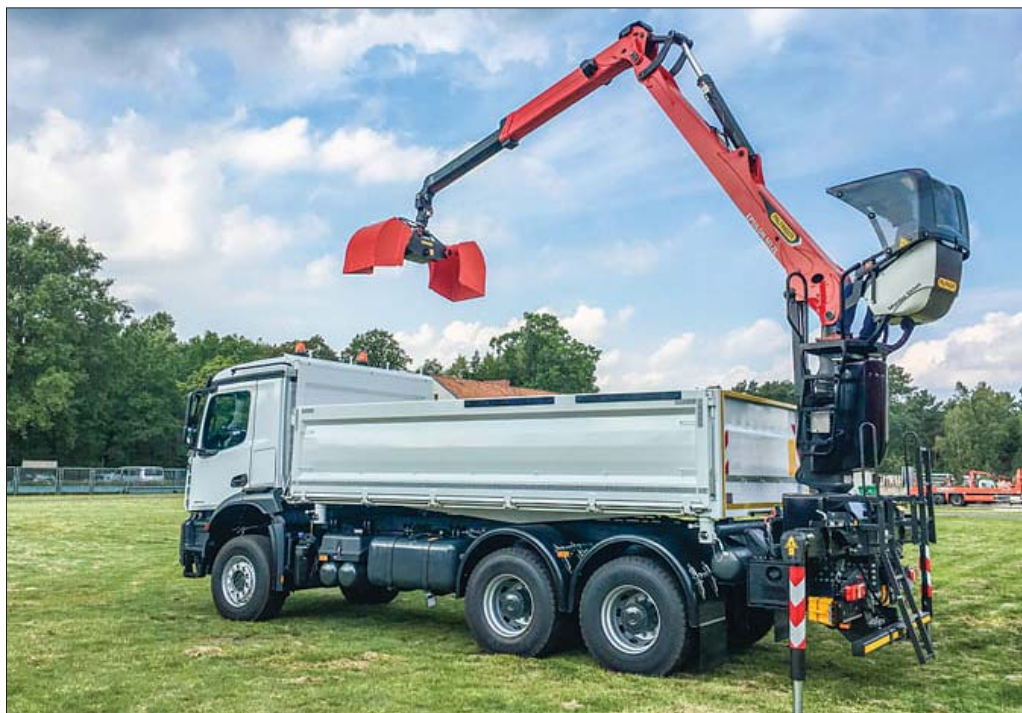
Żuraw Epsilon M12L wyposażony został w długi teleskopowy wysięgnik główny o wprost niesamowitej geometrii roboczej. Pracując z chwytakiem łupinowym urządzenie spisyuje się doskonale na różnego rodzaju placach budowy
