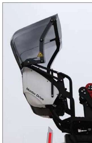
Daszek nad siedziskiem daje operatorowi żurawia optymalną ochronę
