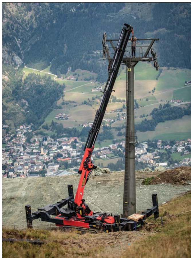
Żuraw osiąga wyjątkowo wysoki udźwieg nawet w trudnych warunkach. Podwozie gąsienicowe jest idealne do przemieszczania się w terenie
