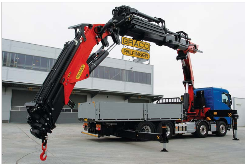
Żuraw Palfinger PK11002 SH ma osiem wysuwanych hydraulicznie sekcji, a dodatkowo zamontowany bocianek kolejnych sześć. Daje to możliwość pracy na maksymalnym zasięgu 34,2 metra i przy udźwigu 820 kilogramów
