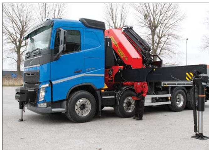
Zamontowana przed kabiną kierowcy piąta podpora skutecznie zwiększa stateczność i osiągi żurawia w czasie wykonywania zadań przed czołem pojazdu
