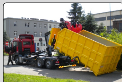
Hakowiec Palfinger obsługujący kontener z zabudowanym żurawiem Epsilon do załadunku i transportu złomu
