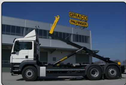
Zabudowy dużych hakowców Palfinger T20 do obsługi kontenerów wg normy DIN 30722
