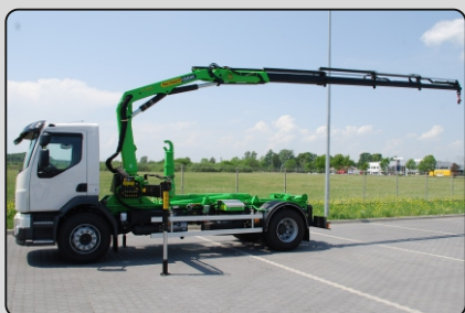
Zabudowy „mały mix” (hakowiec Palfinger T8 + mały żuraw Palfinger)
