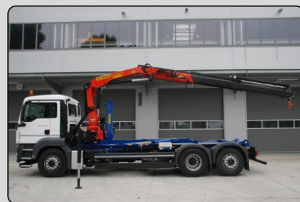
Zabudowy „duży mix” (duży hakowiec Palfinger T20 + duży żuraw Palfinger) na podwoziach 3 osiowych
