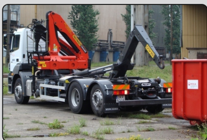
Zabudowy „duży mix” (duży hakowiec Palfinger T20 + duży żuraw Palfinger) na podwoziach 3 osiowych
