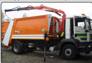
Żuraw Palfinger przeznaczony do obsługi pojemników typu „dzwon” w komplecie ze śmieciarką
