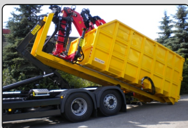
Hakowiec Palfinger obsługujący kontener z zabudowanym żurawiem Epsilon do załadunku i transportu złomu
