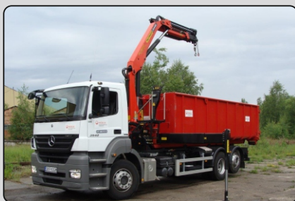
Zabudowy „duży mix” (duży hakowiec Palfinger T20 + duży żuraw Palfinger) na podwoziach 3 osiowych
