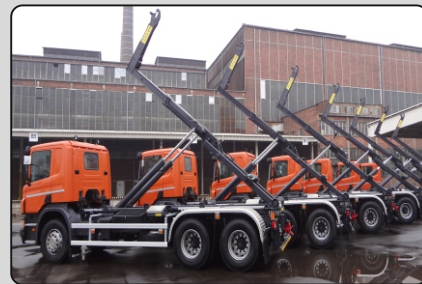
Zabudowy dużych hakowców Palfinger T20 do obsługi kontenerów wg normy DIN 30722
