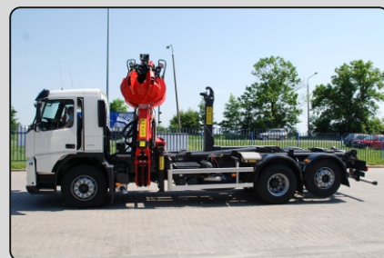
Zabudowy „Epsilon mix” (duży hakowiec Palfinger T20 + żuraw Epsilon) na podwoziach 3 osiowych
