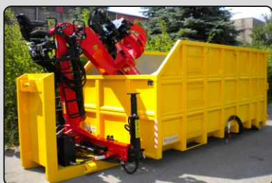
Hakowiec Palfinger obsługujący kontener z zabudowanym żurawiem Epsilon do załadunku i transportu złomu
