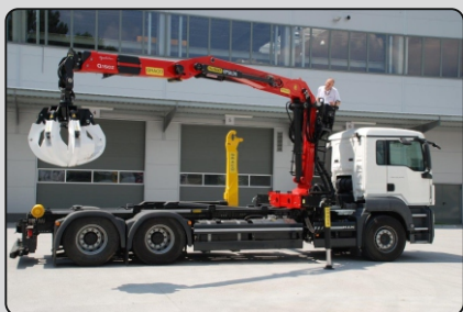
Zabudowy „Epsilon mix” (duży hakowiec Palfinger T20 + żuraw Epsilon) na podwoziach 3 osiowych
