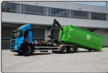
Zabudowy dużych hakowców Palfinger T20 do obsługi kontenerów wg normy DIN 30722
