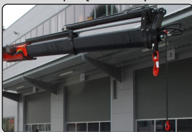
Żuraw Palfinger z zainstalowanym otwieraczem do obsługi pojemników typu „dzwon”
