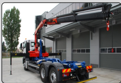
Żuraw Palfinger z zainstalowanym otwieraczem do obsługi pojemników typu „dzwon”
