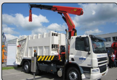
Żuraw Palfinger przeznaczony do obsługi pojemników typu „dzwon” w komplecie ze śmieciarką
