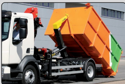
Zabudowy „mały mix” (hakowiec Palfinger T8 + mały żuraw Palfinger)
