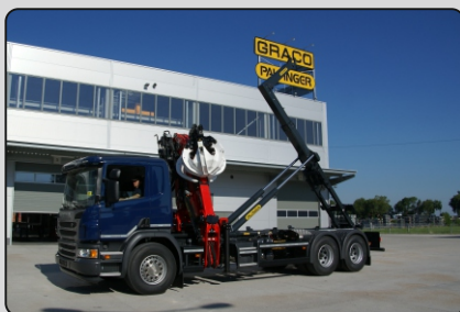
Zabudowy „Epsilon mix” (duży hakowiec Palfinger T20 + żuraw Epsilon) na podwoziach 3 osiowych
