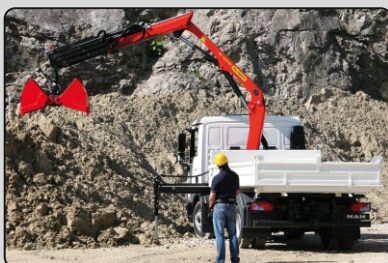
Żuraw Palfinger z chwytakiem dwuszalowym do transportu materiałów sypkich
