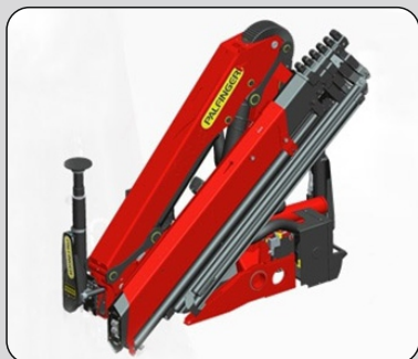
PK 11001 K wysięg - udźwig: 3,7m - 2700kg 5,5m - 1800kg 7,3m - 1340kg
