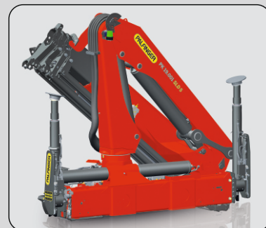
PK 19.001 SLD 5 wysięg - udźwig: 4,2m - 4100kg 6,2m - 2600kg 8,2m - 1880kg 10,3m - 1440kg 12,5m - 1180kg
