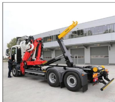
△ Udźwig żurawia Epsilon typu Q150Z96 na maksymalnym wysięgu równym 9,6 m wynosi około 1.500 kg
