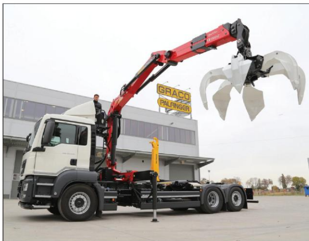
△ Udźwig żurawia Epsilon typu Q150Z96 na maksymalnym wysięgu równym 9,6 m wynosi około 1.500 kg
