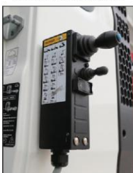
△ Sterowanie „hakowcem” odbywa się za pomocą ergonomicznego pilota przewodowego. Ma on wbudowany magnes, dzięki czemu łatwo go zamocować na ścianie kabiny i obserwować ruchy urządzenia
