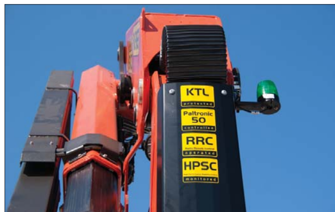
Kataforetyczne zabezpieczenie antykorozyjne i przewody poprowadzone wewnątrz ramienia żurawia podnoszą długowieczność urządzenia
