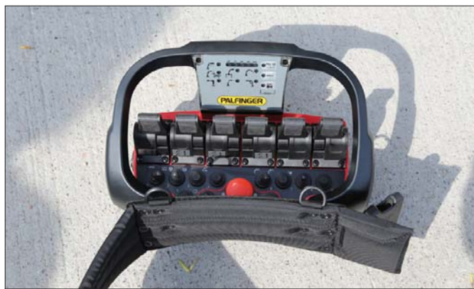
Przenośna konsola umożliwia pracę w pojedynkę i z dala od żurawia. Dzięki temu kierowca-operator może łatwiej nadzorować manipulowanie ładunkiem
