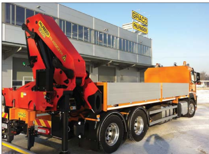
Zdolności transportowe Volvo FM z żurawiem na tylnym zwisie można powiększyć przez dodanie przyczepy, na przykład skrzyniowej lub lawety do transportu maszyn
