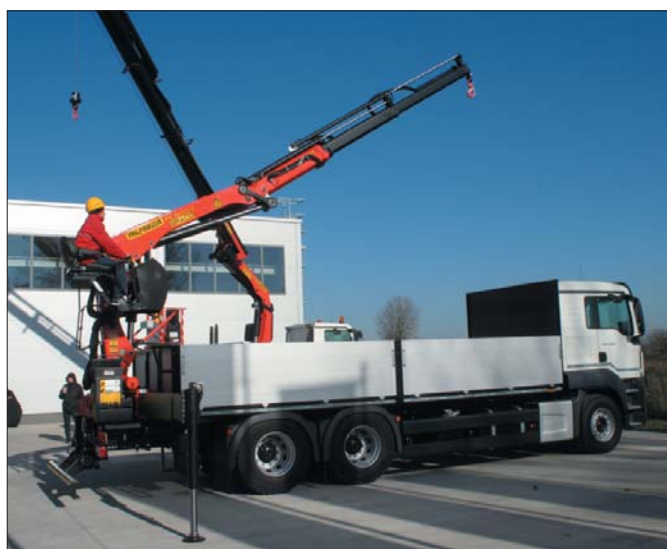
Tak skompletowany pojazd ma masę własną 13.800 kg, co przy DMC równej 26.000 kg oznacza ładowność przekraczającą 12 t
