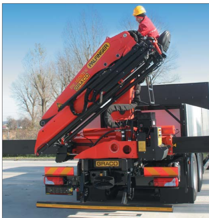
Składanie żurawia w literę „Z” na tylnym zwisie umożliwia swobodne przewożenie ładunków o większej wysokości
