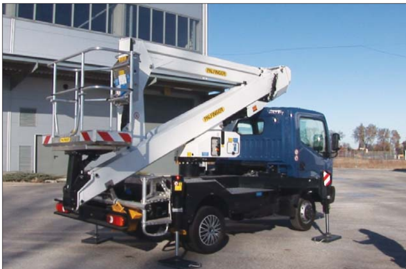
△ Wysięgnik podnośnika składa się w kształt trójkąta, co pozwala w znaczącym stopniu zmniejszyć całkowitą długość pojazdu. W pozycji transportowej wynosi ona tylko 5,39 metra
